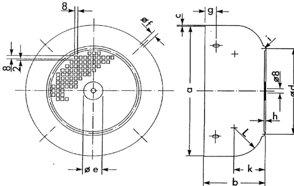
Lüfterhauben, Typen IEC, aus Tiefziehblech, mit Seitenlochung, bis Baugröße 180 roh,
