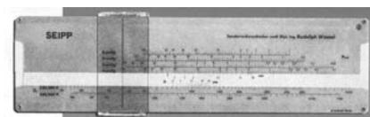
Mit diesen Elektromotoren-Rechenschiebern kann man Elektromotore in sekundschnelle berechnen. Polumschaltbare Drehstrommotoren, Motoren für Kurzzeit -oder Aussetzbetrieb, sowie auch Einphasenmotoren mit und ohne Hilfswicklung können berechnet werden.
