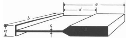
Stabile Ausführung, aus Stahl gefräst, mit Griff, verchromt, in 10 verschiedenen Größen von 3 bis 12 mm. Zum Einstemmen der Drähte in die Nuten von Statoren und Rotoren.
