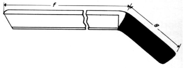
Aus Stahl, in Größen von 2 bis 10 mm Breite.. Diese Schieber finden Verwendung beim Einstemmen der Drähte in den Nuten bei kleinen Statorbohrungen. Sehr große Vorteile bringen sie auch beim Niederdrücken der Nutendeckschieber, so daß ein überaus leichtes und schnelles Einschieben der Keile möglich ist.
